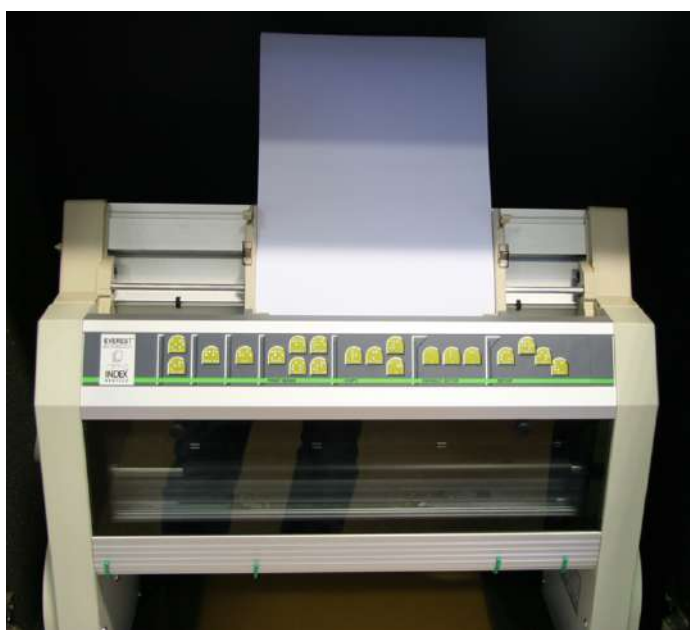
Φωτογραφία 2. Εκτυπωτής Braille
