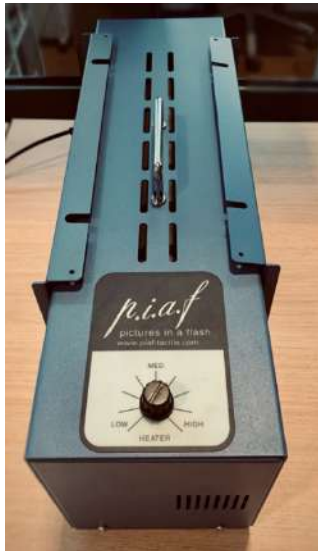
Φωτογραφία 4. Συσκευή παραγωγής ανάγλυφων γραφικών PIAF
